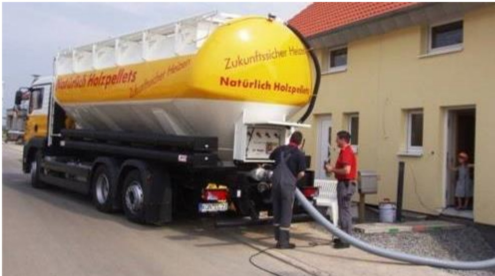
Bild 7: Silolastwagen für Holzpellets. Diese werden mit Druckluft durch den grauen Schlauch gepumpt. Foto Archiv DLM
