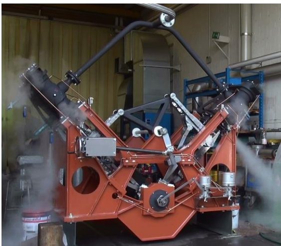
Neu entwickelte Dampfmaschine für DS „Spiez“ Projekt einer neuen Dampfmaschine für Raddampfer
