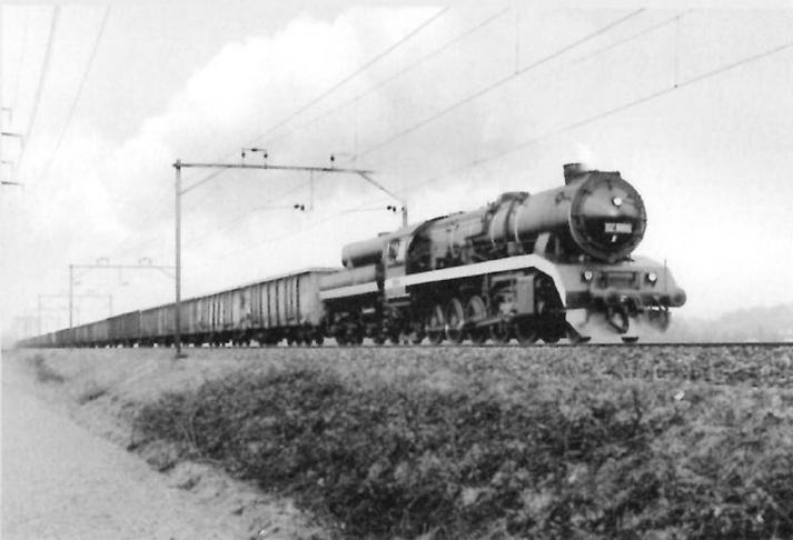
Die französische 242 A 1 aus dem Jahr 1946 nahm es sowohl leistungs- als auch zugkraftmässig locker mit einer der von 1944 bis 1955 gebauten BLS-Hochleistungs-Elektrolokomotiven des Typs Ae 4/4 auf. Geschwindigkeitsmässig übertrumpfte die Super-Dampfmaschine von André Chapelon das BLS-Gegenstück sogar beträchtlich (oben)!
