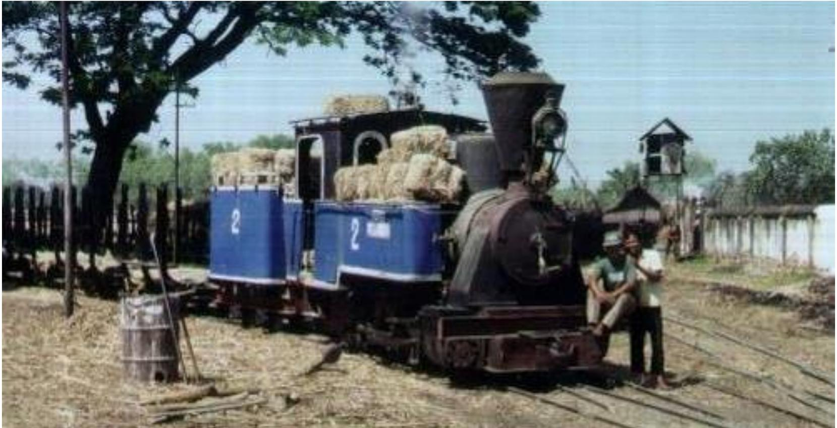
**Beim Auspressen des Zuckerrohrs für die Zuckerproduktion entsteht als Nebenprodukt Bagasse. Seine Verwendung als CO<sub>2</sub>-neutraler Brennstoff für die Zuckermühlen und für die Dampflokomotiven der Werksbahn ist ökologisch vorbildlich und nachhaltig. 100 t Zucker = 34 t Bagasse!**
