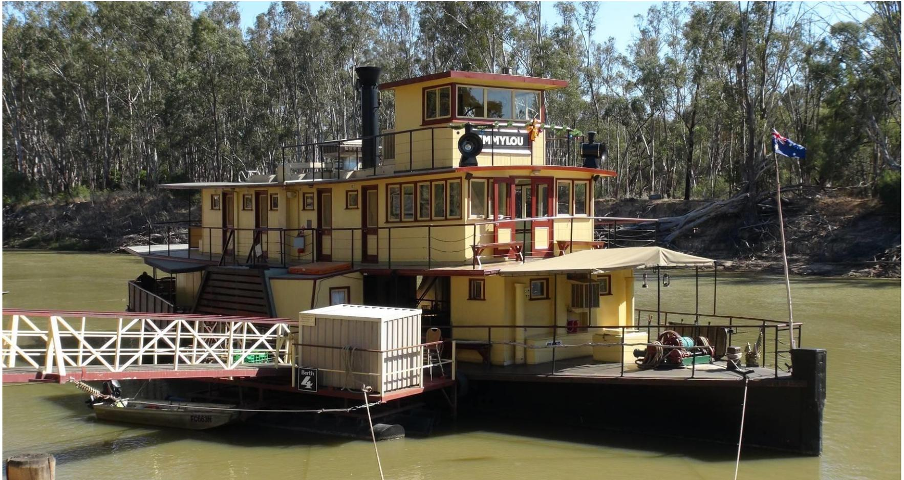
Die vielen auf dem Murray River verkehrenden Raddampfer werden alle mit Eukalyptusholz gefeuert. Während die Dampfmaschine vom Steuerhaus aus bedient wird, übernimmt der Maschinist das Heizen des Kessels.
