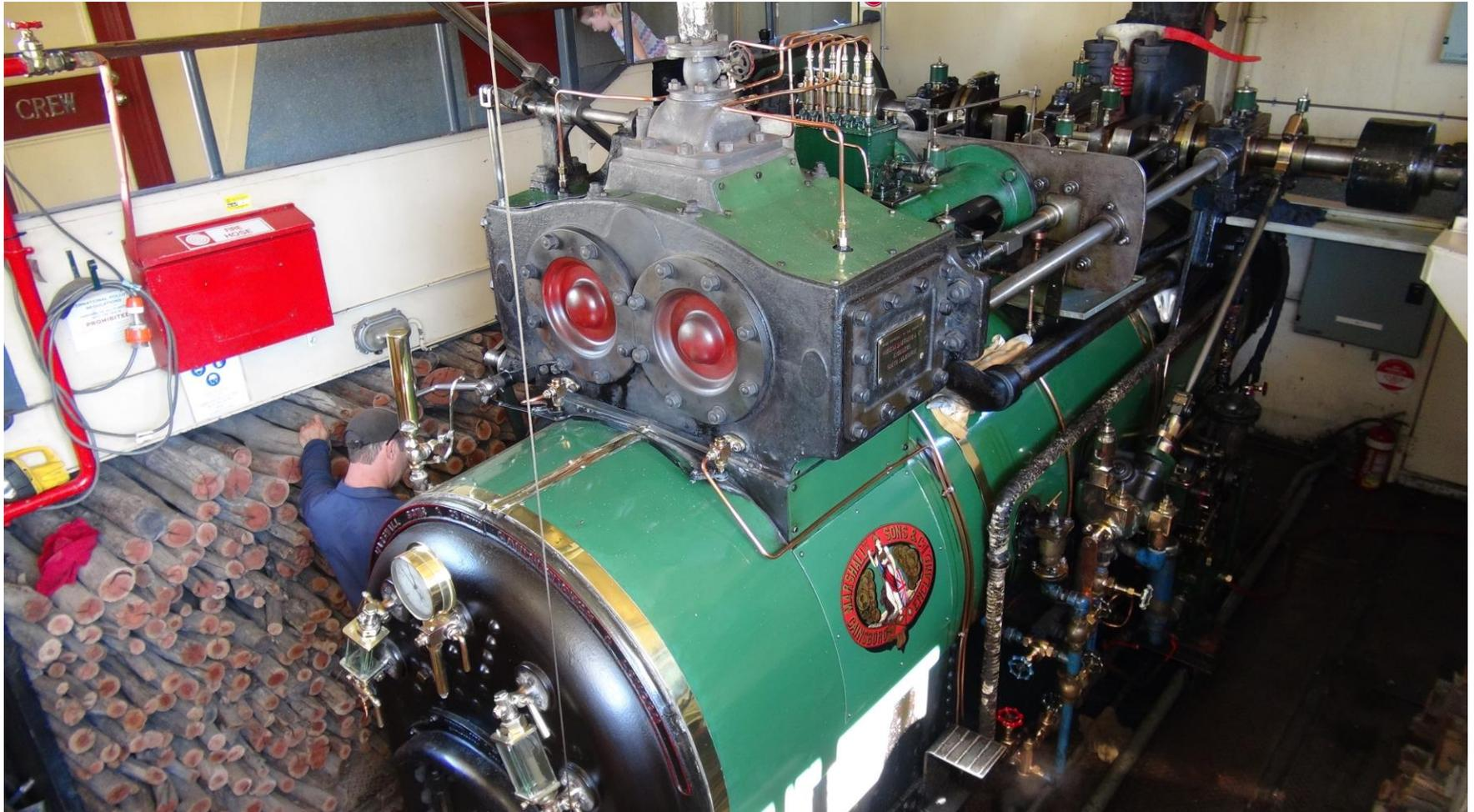
Bei australischen Raddampfern ist die Dampfmaschine wie bei Dampfwalzen und Lokomobilen auf den Kessel gesattelt. Links sieht man den Holzvorrat.
