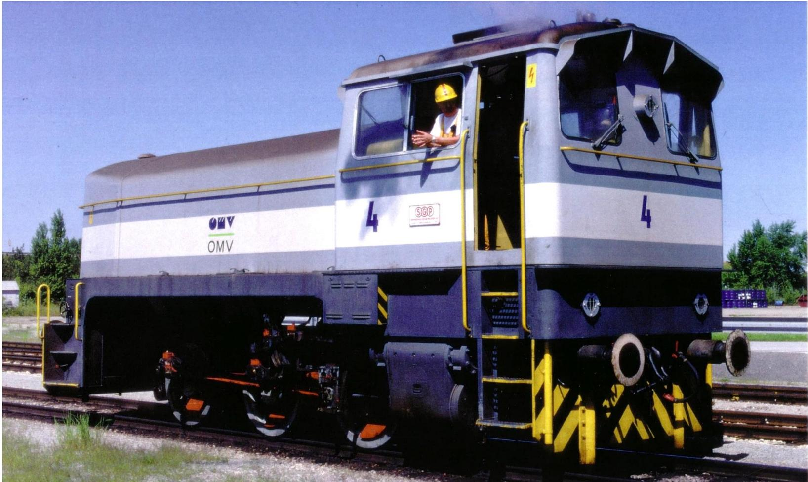
Hochdruckspeicherlokomotiven werden für Ladedrücke bis 120 bar gebaut. Nach der Drosselung des Speicherdampfes auf den Arbeitsdrucks von 16 bar wird der Dampf überhitzt (besserer Aktionsradius).
