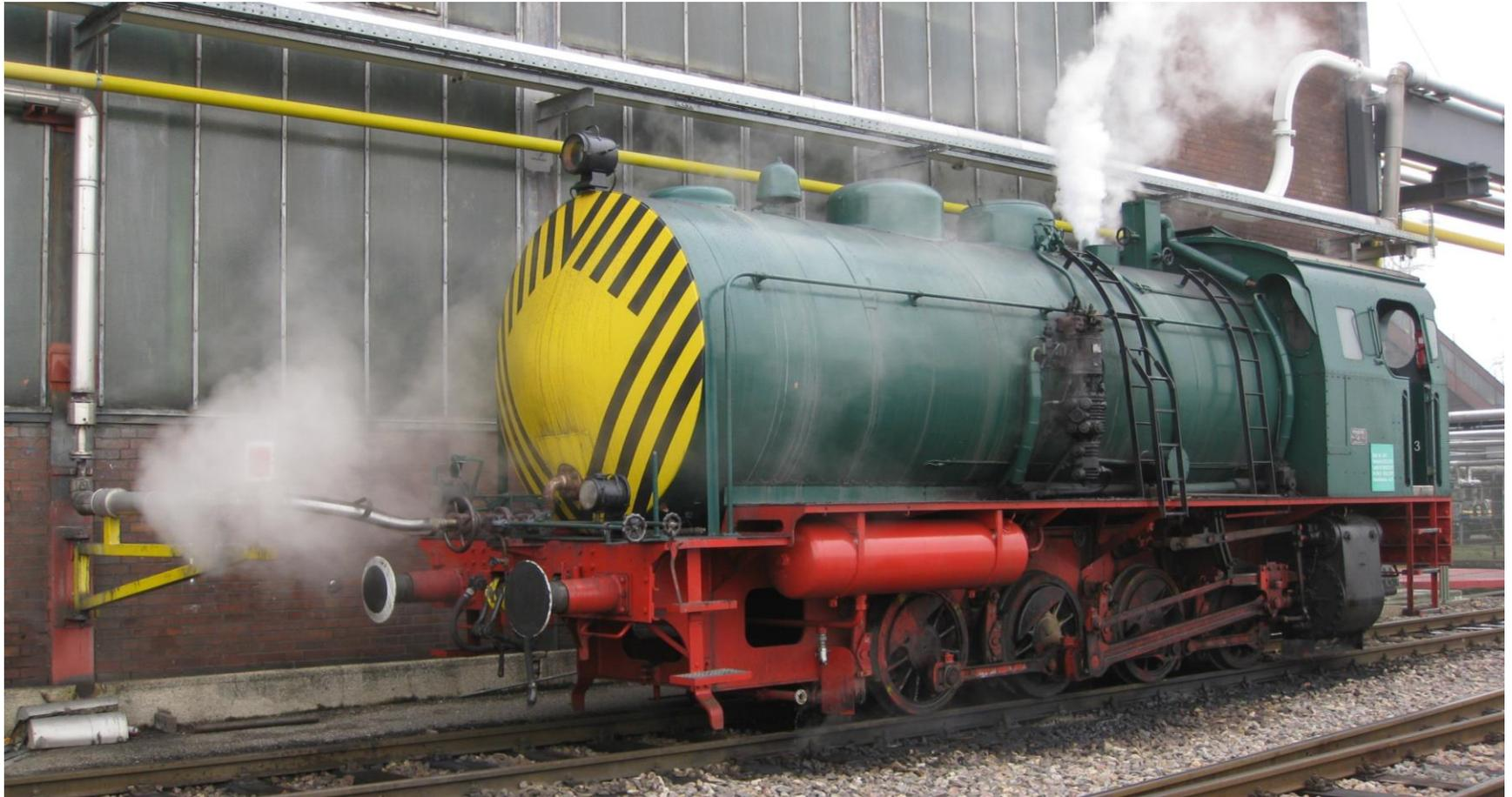
Eine der beiden vierachsigen Dampfspeicherlokomotiven des GKM (Grosskraftwerk Mannheim) an der Ladestation. Das nachladen erfolgt mit kraftwerkseigenem Dampf von 20 bar in nur 15 bis 25 Minuten. Diese Lokomotiven ziehen 4'000 t-Züge.
