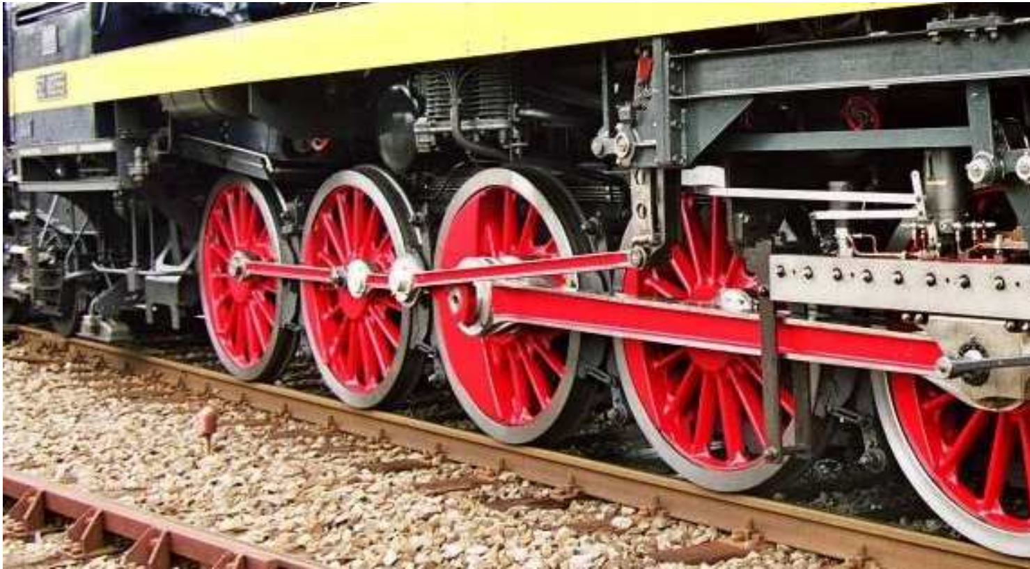
Rollenlagertriebwerk der modernisierten Dampflokomotive 52 8055
